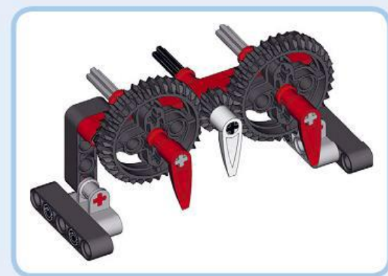
Рис. 11.9. Зубчатая передача с колесами 36Т (слева), 12Т (в центре) и второго 36Т (справа)
